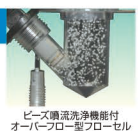
ビーズ噴流洗浄機能付 オーバーフロー型フローセル
